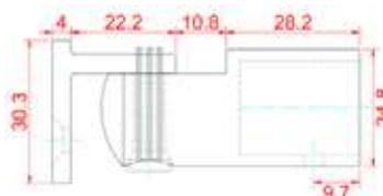
**GL-CN003****CONECTOR PARED TUBO A 45 GRADOS**
