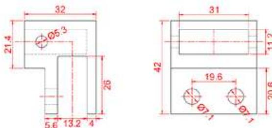
**GL-CN017****CONECTOR PARA TUBO 30X10 A VIDRIO**FABRICADO EN ACERO INOXIDABLE AISI 304
